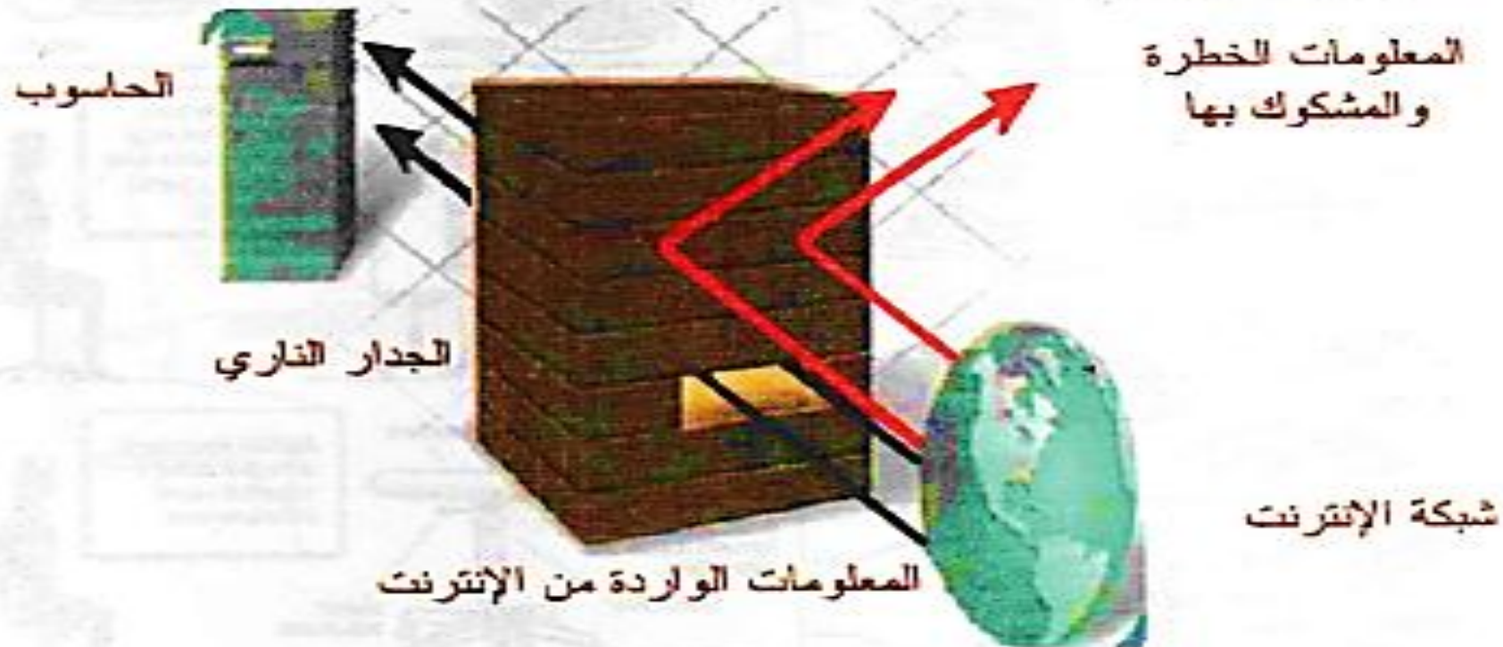
الشكل (3-3) تفعيل عمل الجدار الناري لحجب المعلومات الخطيرة عن الحاسوب
