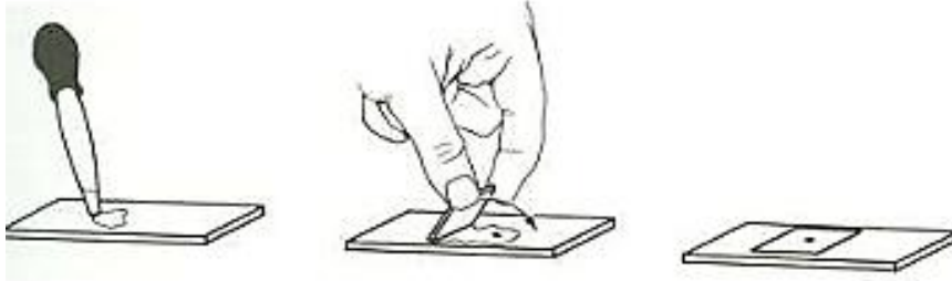
شكل (2) كيفية عمل شريحة رطبة
