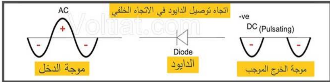
الشكل 2: شكل الموجة الخارجة عند ربط الدايمود بانخياز عكسي
