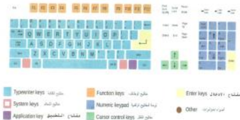
الشكل (4-2) التقسيم النموذجي ل لوحة المفاتيح
