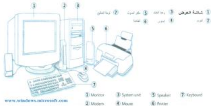
الشكل (1-2) يبين الأجزاء والملحقات الرئيسية للحاسوب المكتبي
