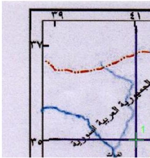
باستخدام الماوس الايسر نحدد موقع نقطة الارجاع (بكل دقة) ثم نضغط الماوس الايمن فنفتح نافذة بها امر Input X and Y لادخال قيم الاحداثيين X , Y الحقيقيين لهذه النقطة :
