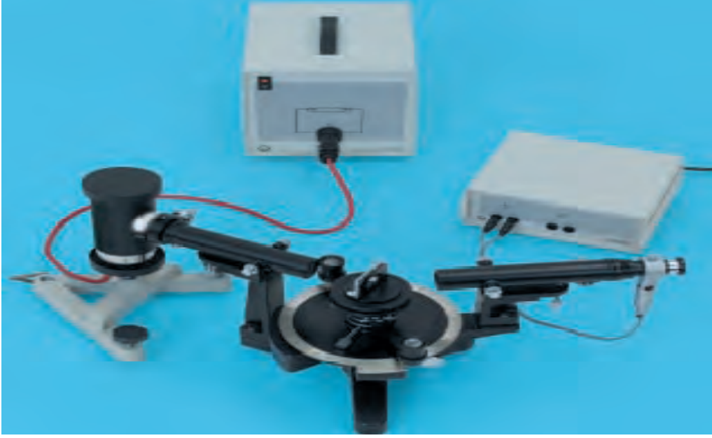
شكل (2) يبين جهاز المطياف
