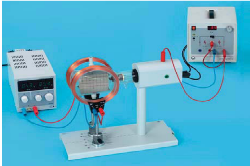
شكل (2) يبين جهاز تومسن
