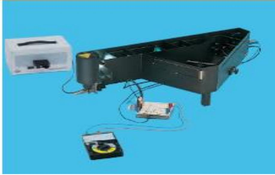
شكل (4) يبين جهاز الخلية الكهروضوئية
