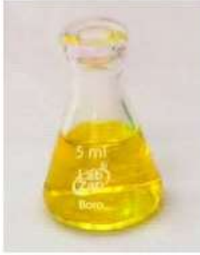
قبل التسحيح محلول \text{NaCl} + \text{K}_2\text{CrO}_4
