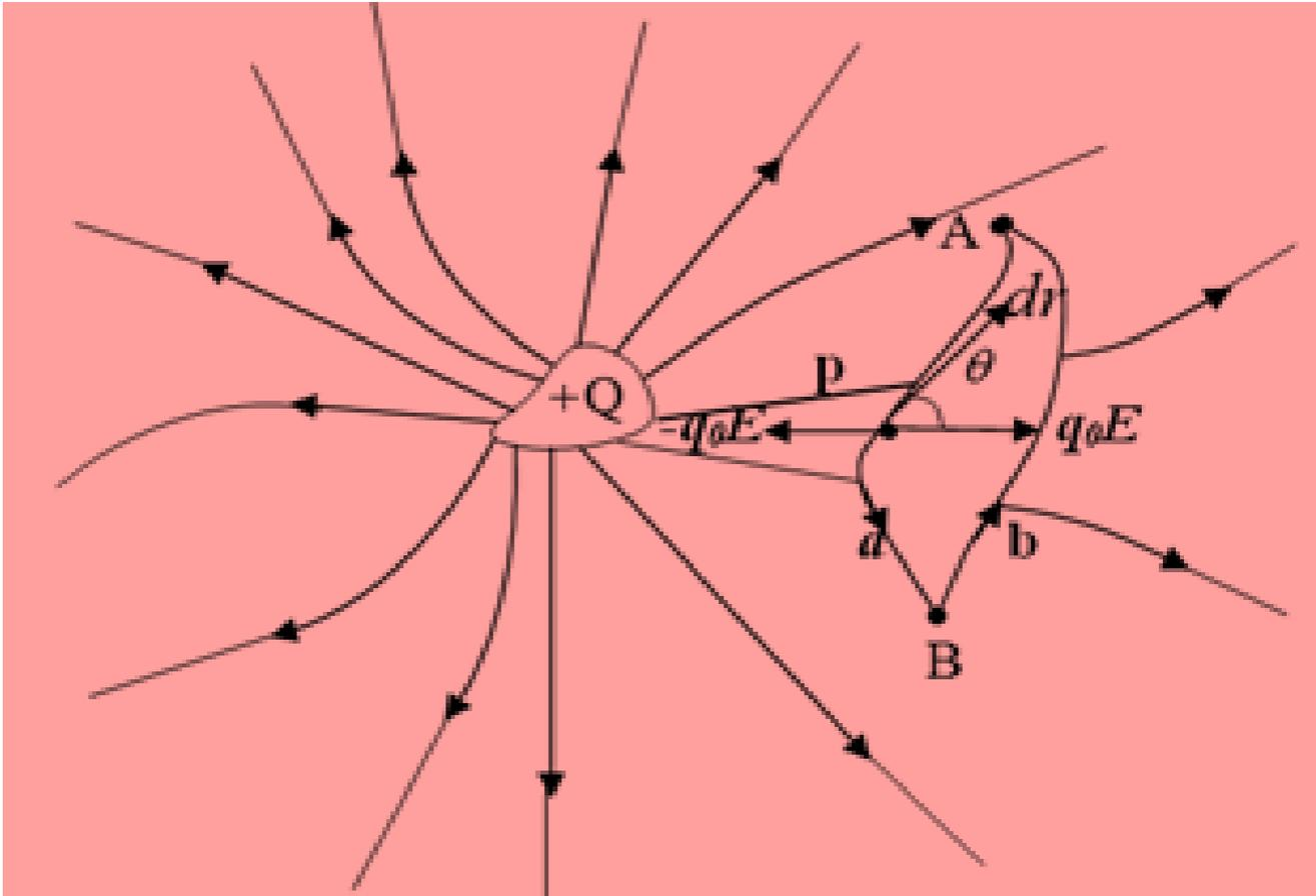
فرق الجهد بين النقطتين A وB داخل المجال الكهربائي : هو الشغل المبذول ضد القوة الكهربائية لنقل وحدة شحنة الاختبار الموجبة من A إلى B.
