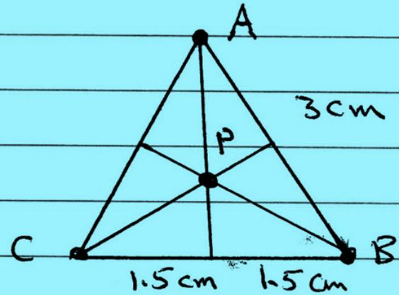
$$V_p = V_1 + V_2 + V_3 = 9 \times 10^9 \left[ \frac{2 \times 10^{-6}}{1.73 \times 10^{-2}} + \frac{2 \times 10^{-6}}{1.73 \times 10^{-2}} + \frac{2 \times 10^{-6}}{1.73 \times 10^{-2}} \right]$$
