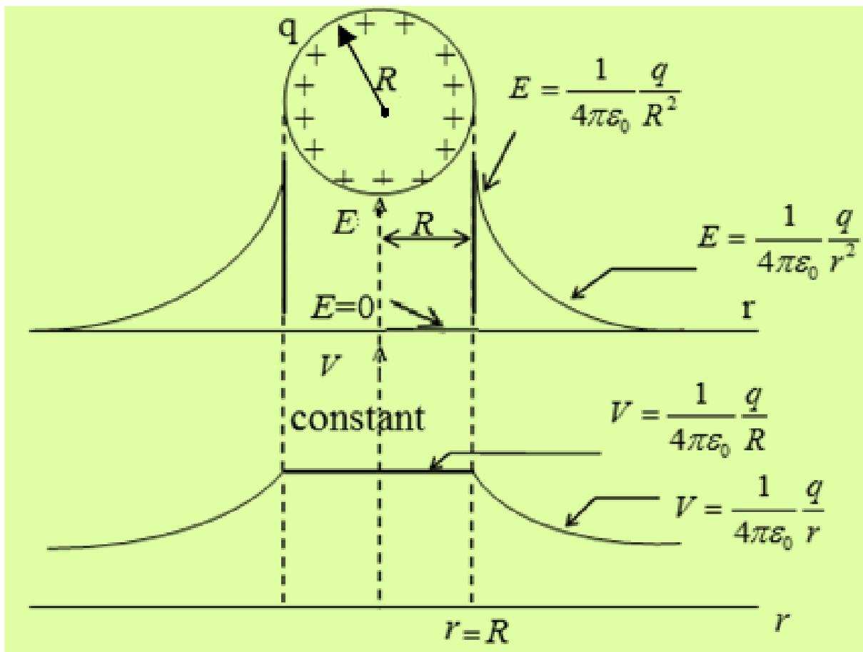
يبين الشكل توزيع كل من مقدار شدة المجال الكهربائي والجهد داخل كرة موصلة وخارجها نصف قطرها  $R$  ومشحونة بشحنة موجبة مقدارها  $+q$ .
