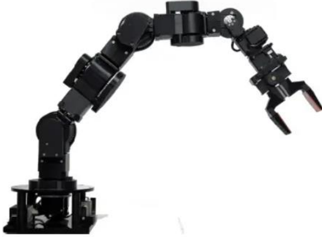
صورة 5.5: ذراع آلية يمكن عملها عن طريق الأردوينو
